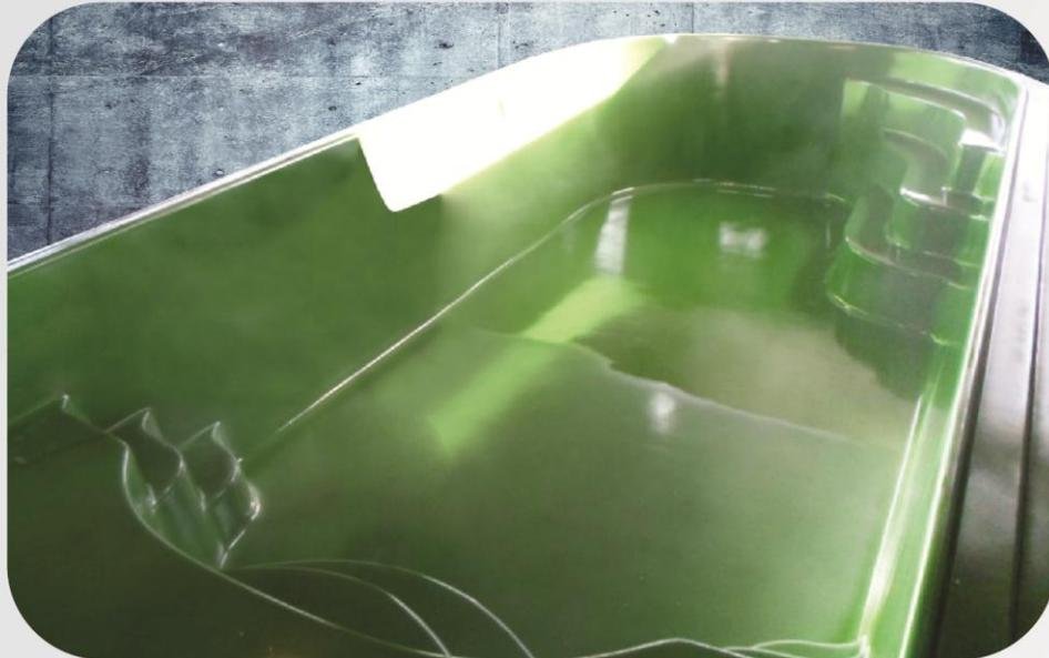
Molde sendo retirado do pré molde para a fabricação da piscina.
